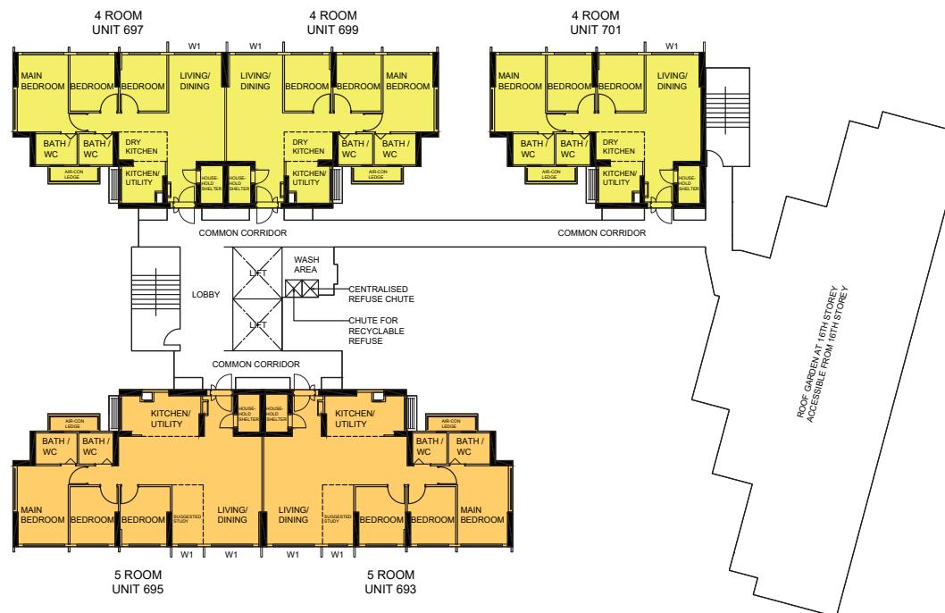
BLOCK 213C | 16TH STOREY FLOOR PLAN
