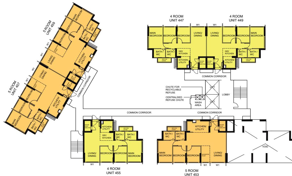
BLOCK 216D | 8TH STOREY FLOOR PLAN
