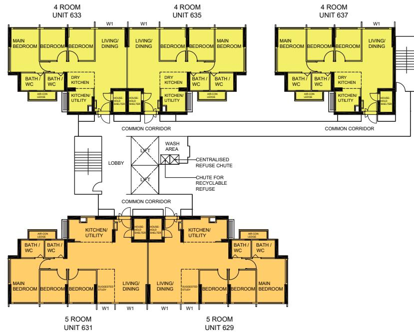
BLOCK 212C | 12TH STOREY FLOOR PLAN
